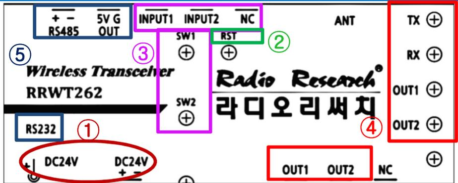
① **전원부** : DC24V는 전원 24V입력으로 아답터 전원을 이용하기 위해 준비되어있다. ( DC JACK / 외경-5.5파이 / 내경-2.0파이 ) VCC INPUT 단자는 현장에서 24V 전원을 터미널 블럭을 통하여 전원을 공급할 수 있고, 아답터를 사용할 수 도 있다. 컨트롤러는 전원을 공급하면 사용대기 상태가 된다.
